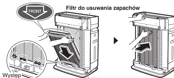
Filtr odpylający Filtr odpylający ma specjalną orientację. Przed założeniem sprawdź symbol w górnej części filtra.
